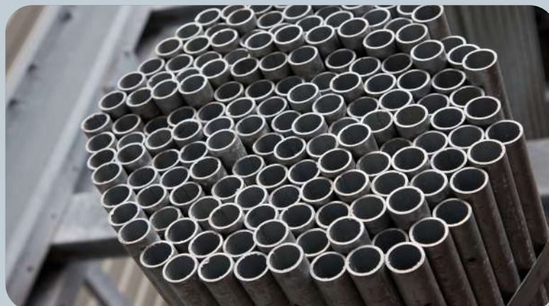
Protection anti-corrosion de tubes en bottes, par immersion.
